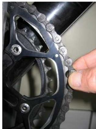
**2<sup>ème</sup> méthode** : on va utiliser un outil qui indique l'usure de la chaîne
